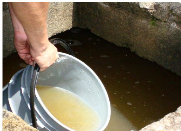
Figura 4. Toma de muestras de la planta de tratamiento de la Hacienda La Montaña.
