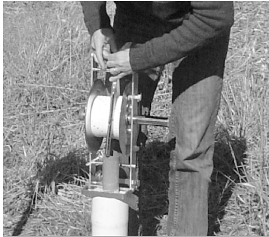
Figura 4. Sonda manual de nivel freático con señal acústica y luminosa.
