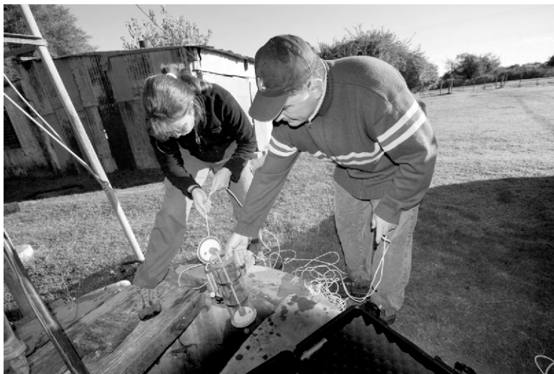
Figura 5. Muestreador de agua Van Dorn.
