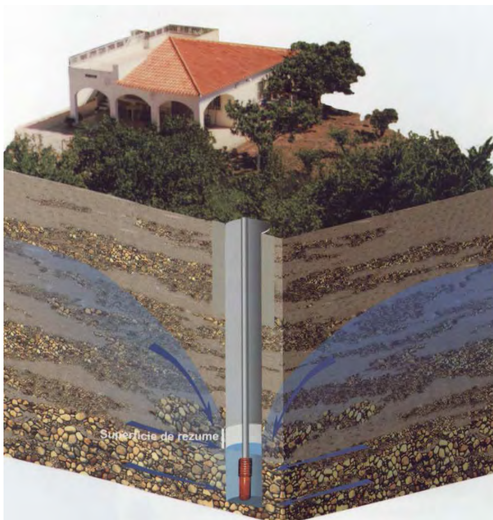
Figura 4.: Captación de un acuífero libre mediante un pozo excavado (López, 2001).
