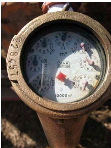
**Caudalímetro utilizado para efectuar las mediciones de volumen**
