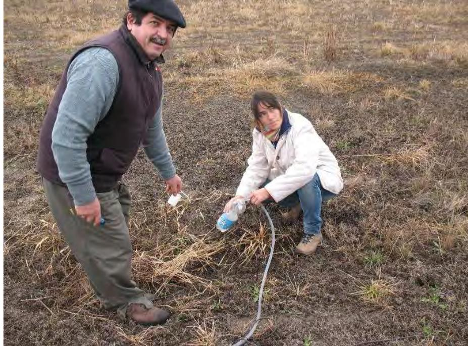
Realizando los controles de conductividad eléctrica en las perforaciones
