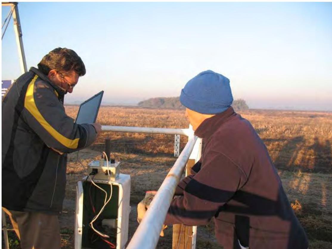
Reinstalación del freatígrafo digital una vez que se realizó la limpieza de la perforación
