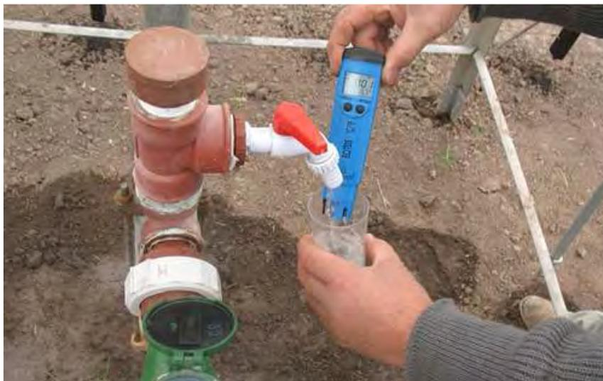
**Fig. 8- Medición de la conductividad eléctrica en el Sistema A.**
