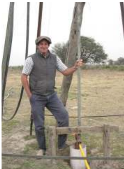
Patricio Magiollo mostrando el sistema de antepozo de la bomba del molino para aspirar a profundidades mayores a 7-8 m del nivel dinámico del agua subterránea.
