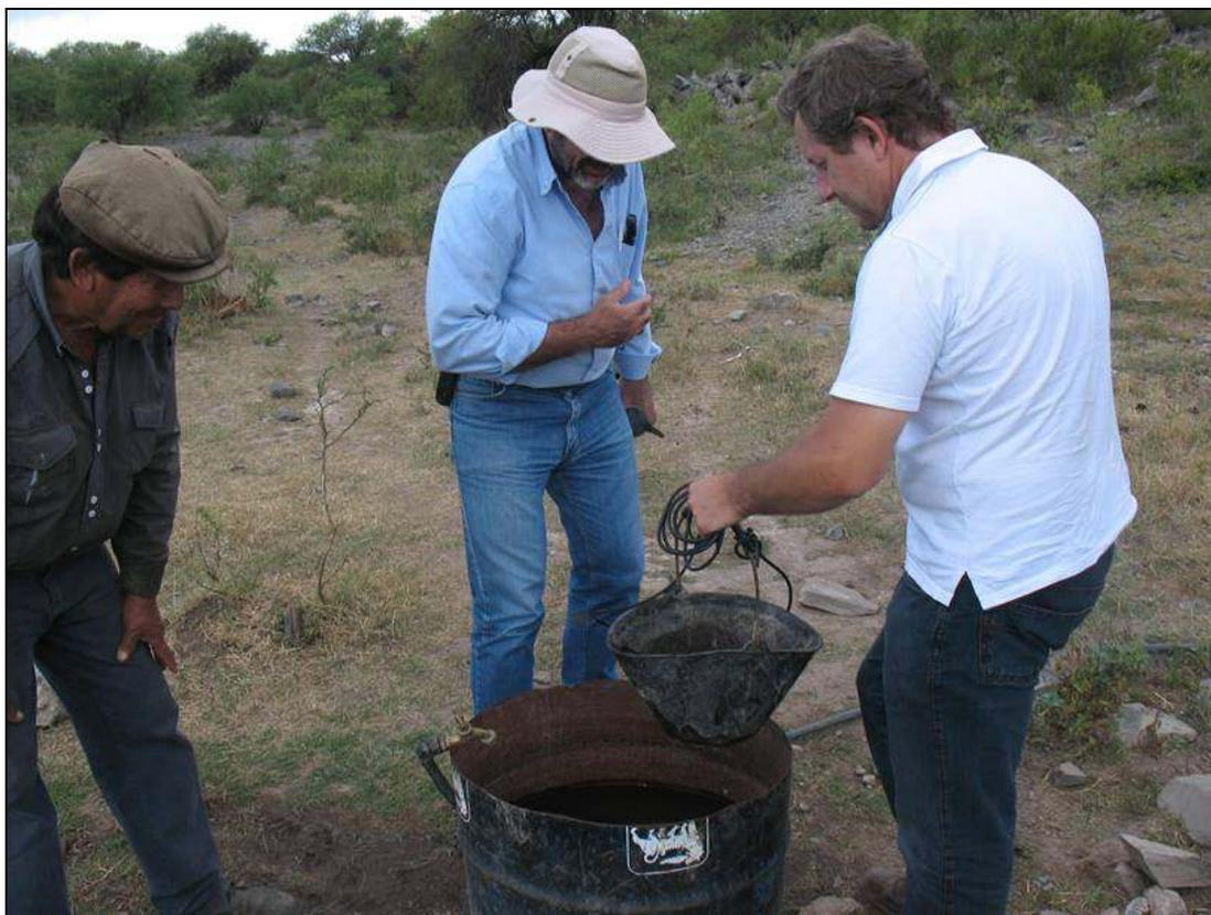
**Analizando el agua de la perforación.**
