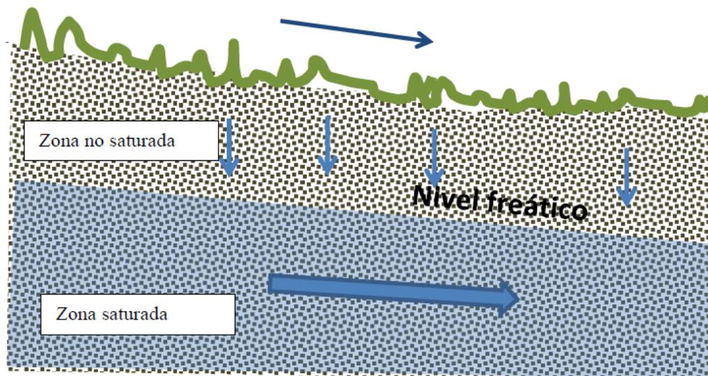
**Figura 2:** Movimiento de la freática sin alteración de la superficie del suelo.
