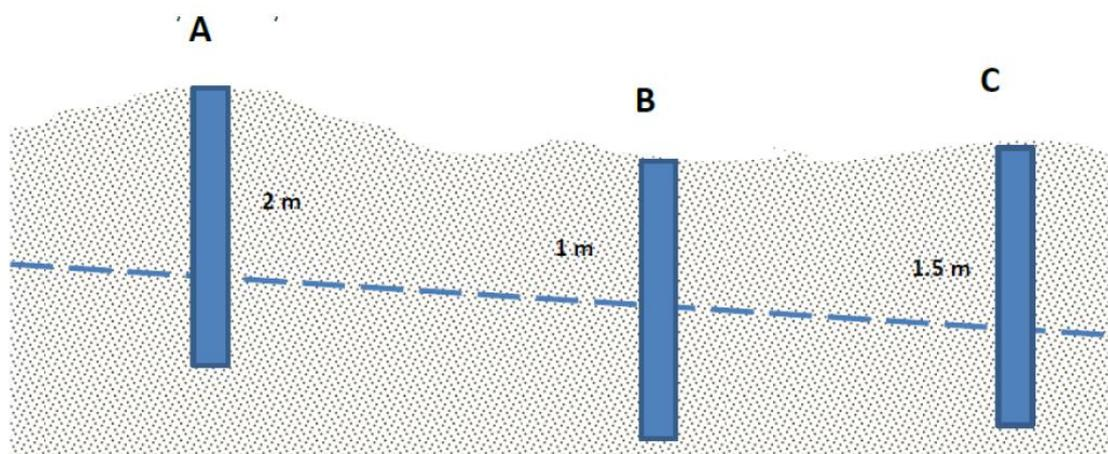
**Figura 5:** Supuesto erróneo del movimiento de la freática.
