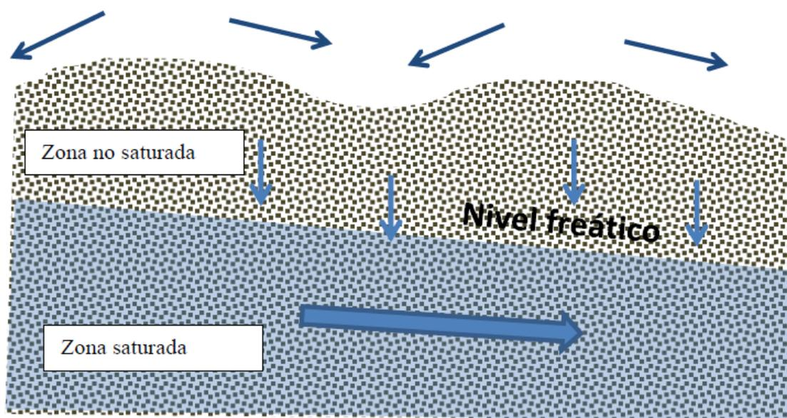
**Figura 3:** Movimiento de la freática, con alteración de la superficie del suelo.
