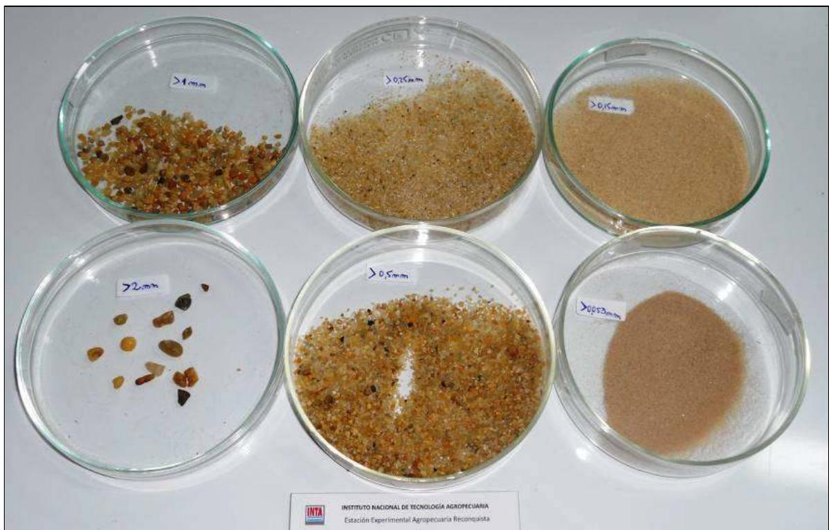
**Figura 2: Fracciones analíticas de suelo resultantes en la muestra N°25 a los 23 m de profundidad.**
