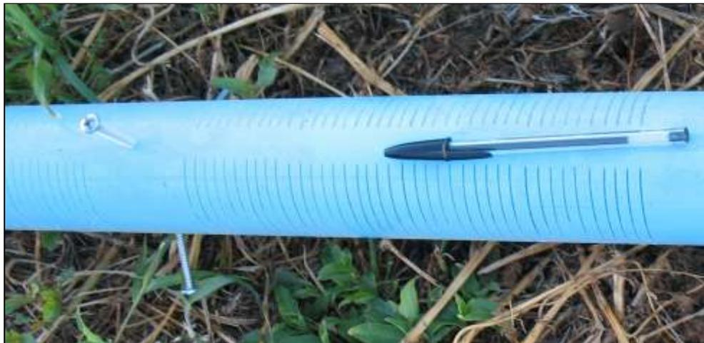
**Filtro artesanal construido por la Empresa de 75 mm de diámetro. Obsérvese los tornillos guía para un buen centrado dentro del caño camisa y poder engravar de manera uniforme.**
