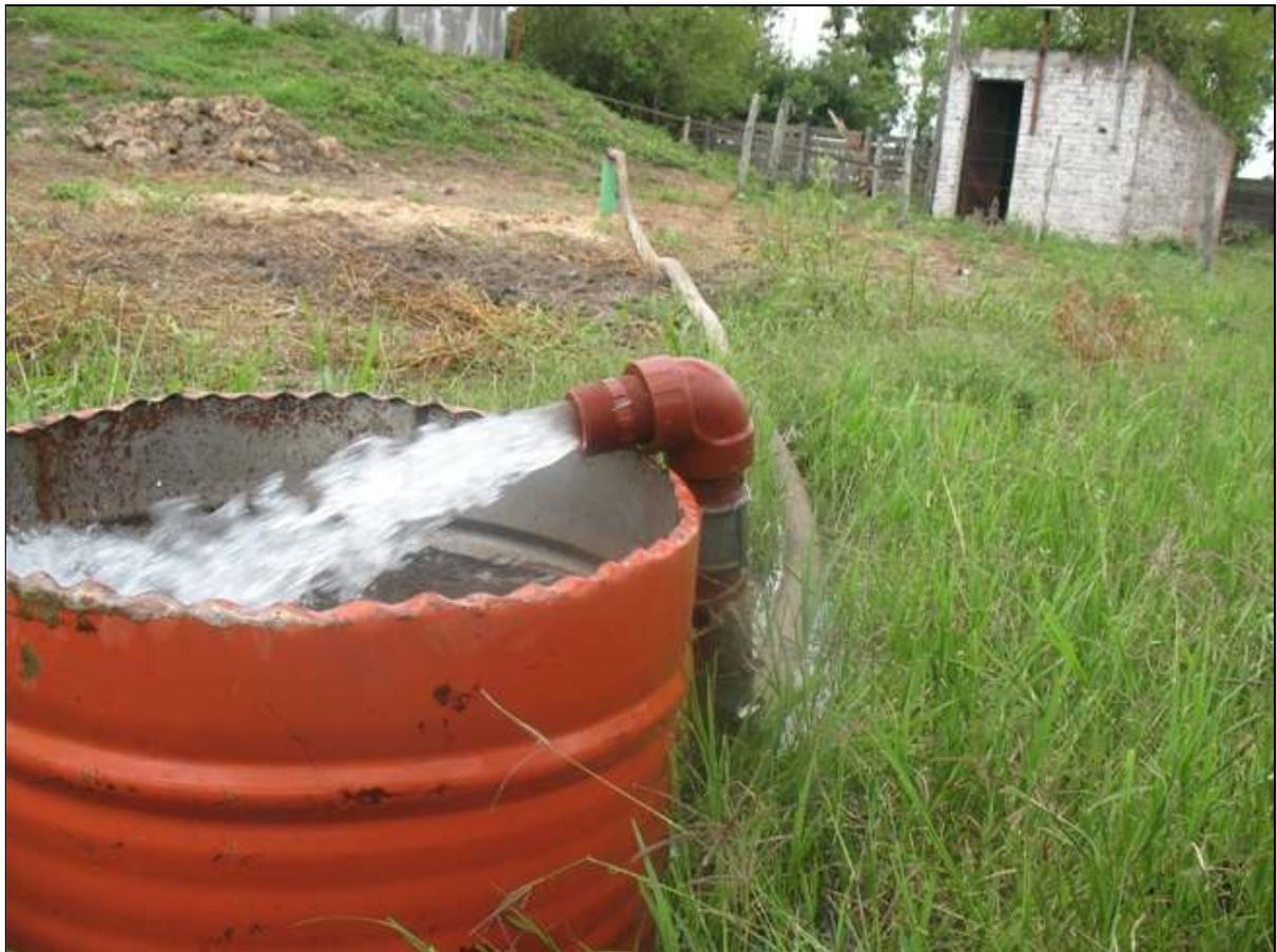
**Aforo volumétrico de la perforación donde se comprobó que extrae 12.000 l/h.**
