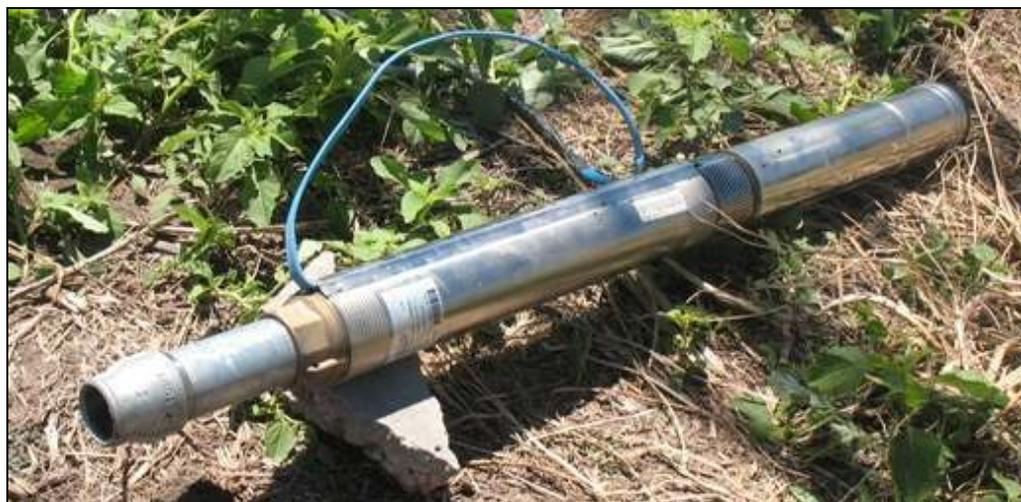
Electrobomba sumergible con buje reductor para adaptarla a la cañería del molino.
