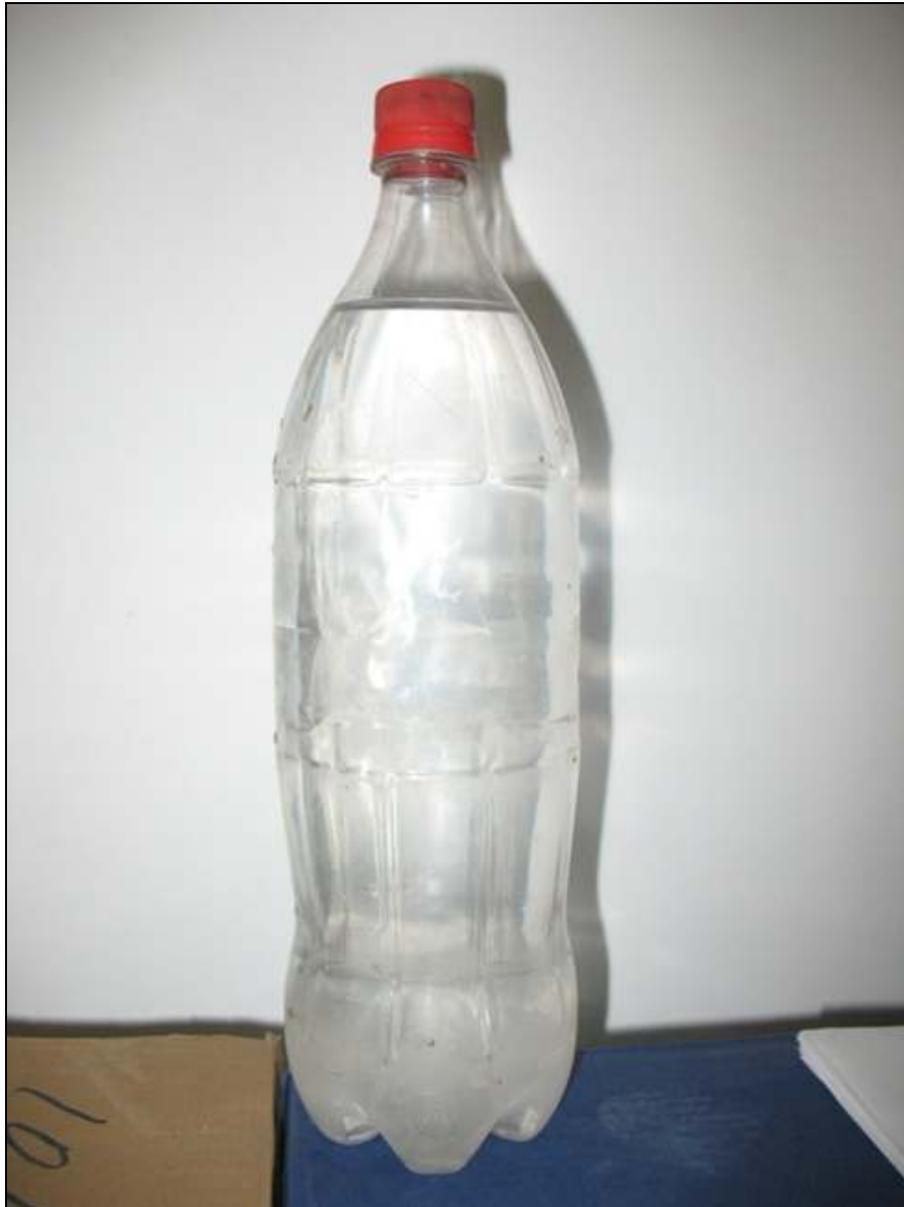
**Muestra de agua tomada para análisis químico. Se aprecia la no presencia de sedimentos.**
