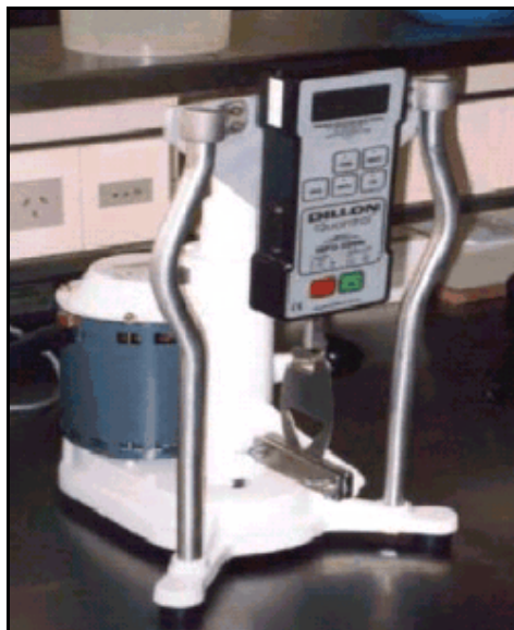
Foto Nº 1: Cizalla Warner-Bratzler (Laboratorio INIA Tacuarembó).
