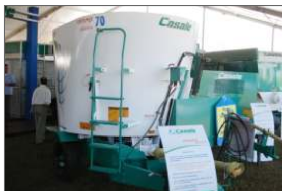
Figura 2.2. Mixer con sistema de transmisión de datos en tiempo real, sobre carga y descarga de alimentos.
