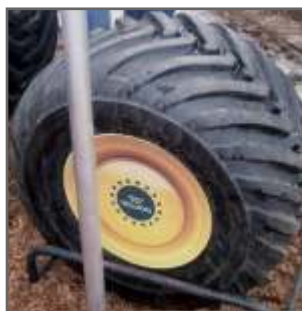
Figura 2.11. El neumático con el cual se equipa al mixer debe poseer características que aseguren el poder cumplir con la tarea de alimentación independientemente de las condiciones climáticas reinantes.
