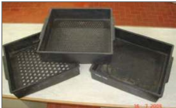
Figura 2.35. Derecha: Zarandas de Separador de Partículas “Penn State”. Izquierda: procedimiento de trabajo con una TMR.
