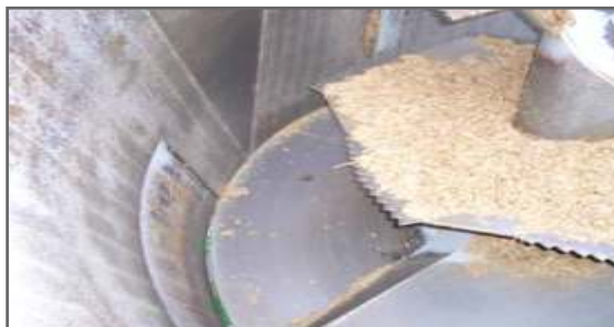
Figura 4.3. Se observa algún desgaste de la pintura interna
