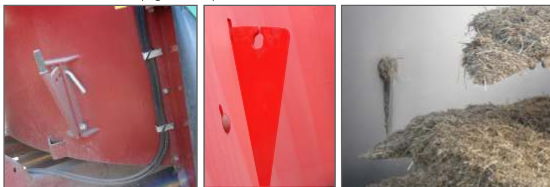
Figura 2.12. Exterior e interior de los frenos que determinan el grado de cortado o desmenuzado de la fibra incorporada a la ración.
