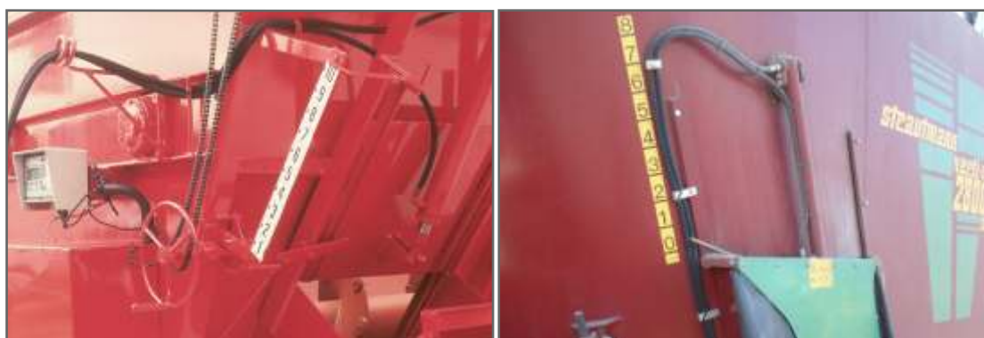
Figura 2.8. Regla indicadora de la apertura de la puerta de descarga.
