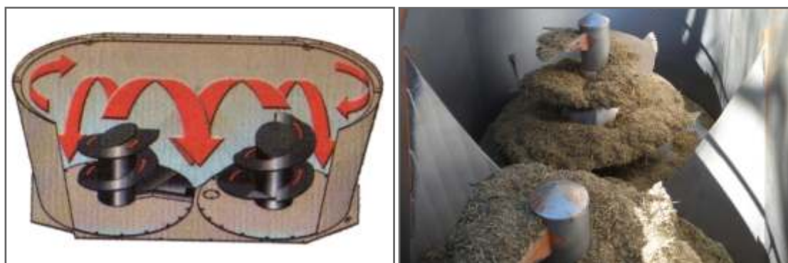
Figura 2.14. Doble sinfín de mezclado en acoplado de mayor capacidad de carga y trabajo (Fuente: INTA PRECOP, 2009).
