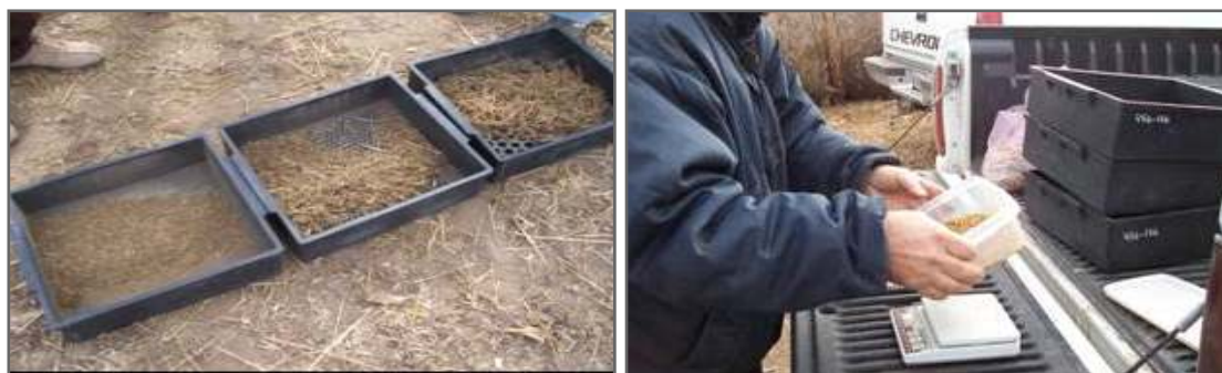
Figura 3.3. Separador de partículas Penn State, vista del heno luego de procesado con el mixer "J".
