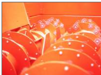
Figura 2.21. Dos sinfines horizontales con cuchillas periféricas.
