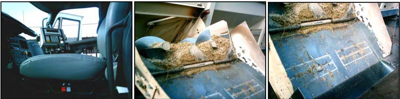
a)-Interior del camión mixer, con computadora que le indica al conductor el corral, la cantidad que debe proveer y lo que va descargando; b)-Descarga del mixer; c)-Fueres imanes para retener objetos metálicos en la boca de descarga del mixer; observar los alambres retenidos
