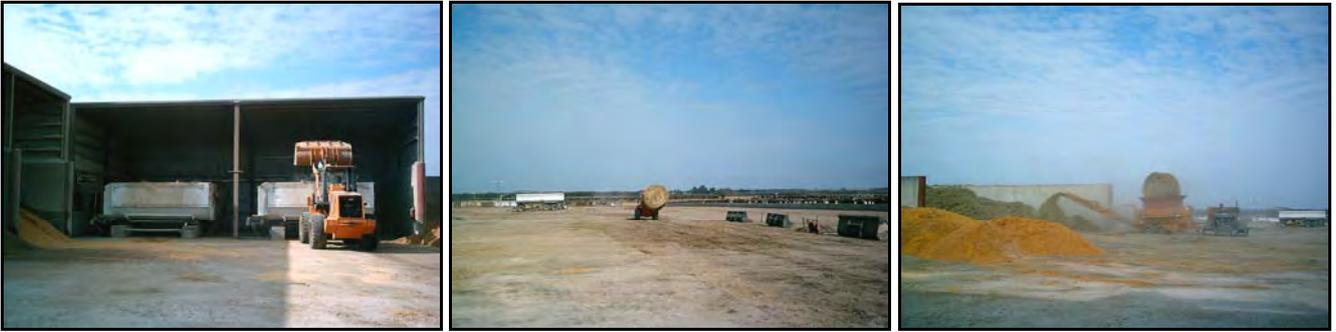
a)-Descarga de la pala en la balanza; en una pantalla se le indica al conductor los kg que faltan cargar de cada componente.
