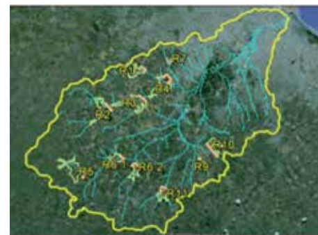
Figura 6. Localización de reservorios para el control de inundaciones ribereñas en la cuenca Matanza-Riachuelo, Argentina.
