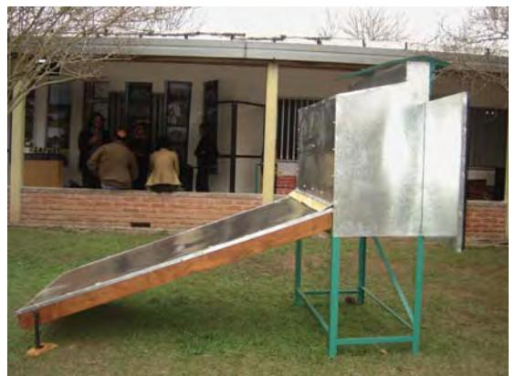
El secador solar cuenta con una cámara de secado acoplada a un colector solar. El aire se calienta en el colector solar y circula por la cámara de secado por convección natural. En la cámara de secado se colocan bandejas de secado con el producto a deshidratar.
