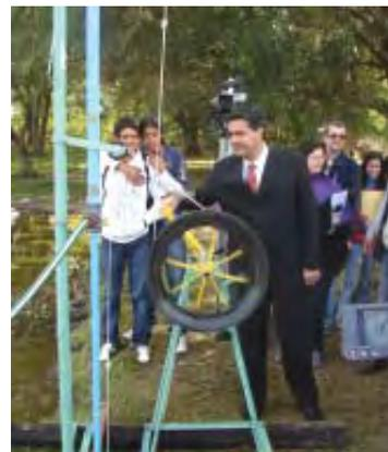
Está diseñada para la provisión de agua para casas, escuelas, salones y otros lugares donde se reúne gente. Si se instala el modelo Jirafa, permite elevarla y almacenarla en tanques que abastecen de agua corriente a estos lugares.
