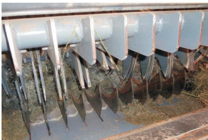
Figura 9. Sistema procesador de fibra con 14 cuchillas
