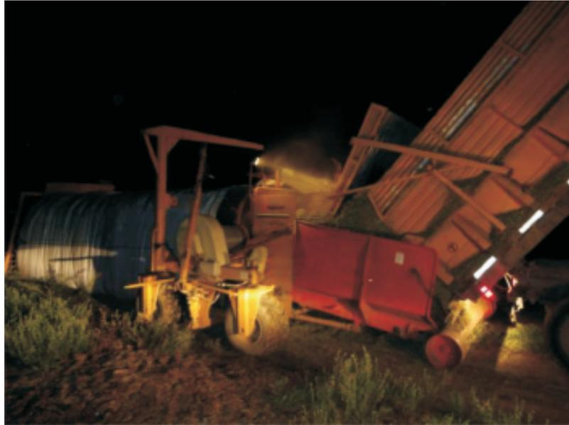
Figura 14: material descargado por el camión volcador en la embolsadora Implecor modificada
