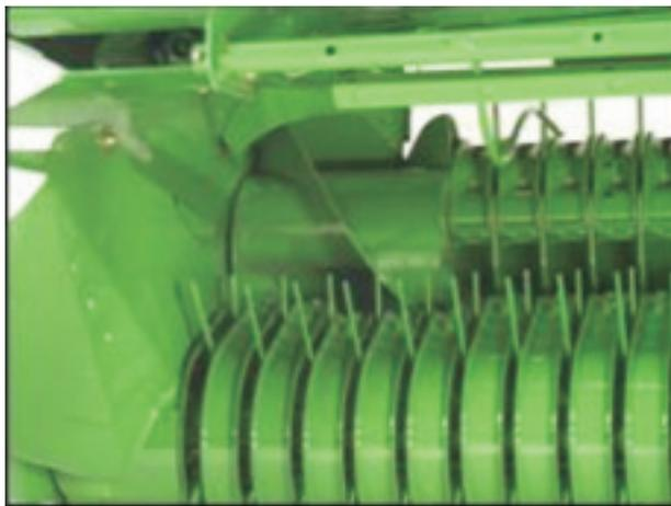
Figura 7: Recolector más ancho que la cámara de compactación.
