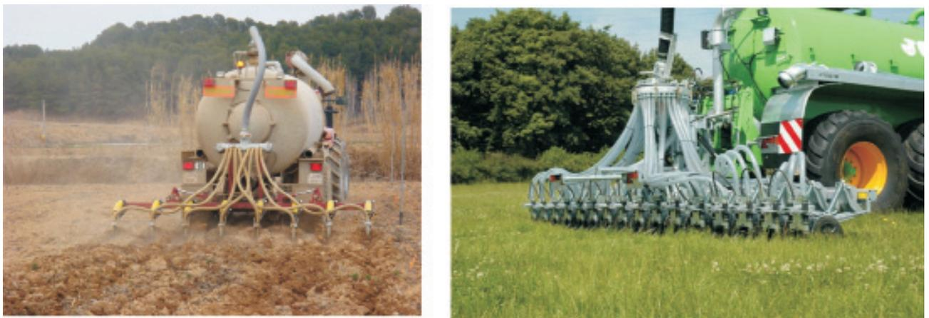
**Figura 7:** Aplicación mediante enterrador con reja (izq) e inyección (der).
