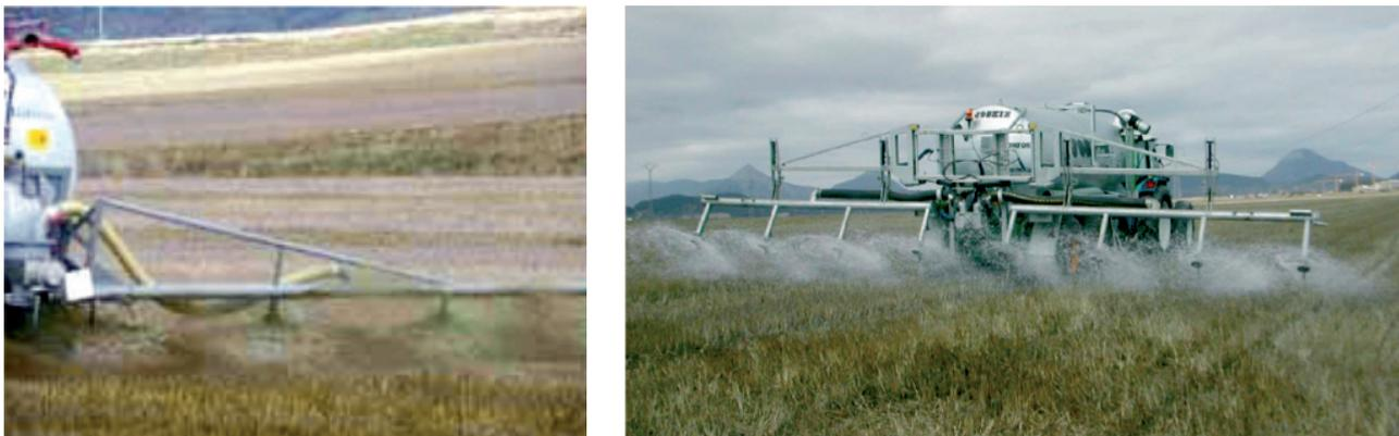
**Figura 5:** Aplicación con sistema de barra de distribución con multiboquillas.
