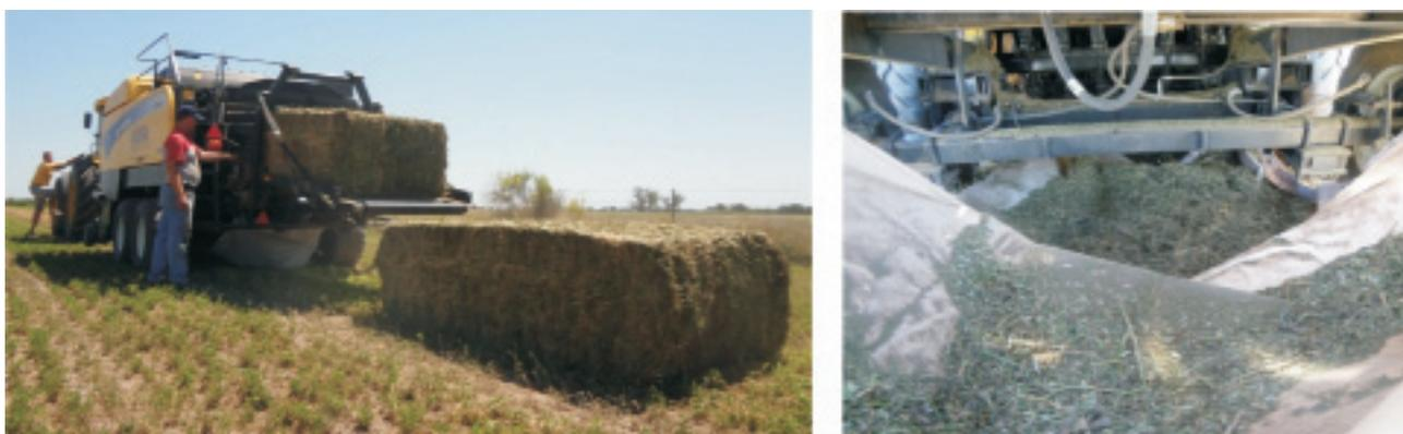
Figura 10: Ensayo de medición de pérdidas en cámara de compactación en megaenfardadora.
