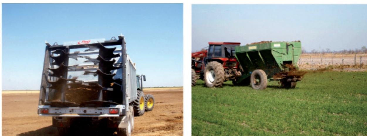
**Figura 3:** Remolque distribuidor de estiércol sólido
