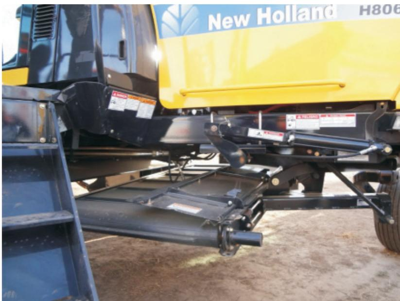
Figura 3: detalle del desplazador de andanas en segadoras
