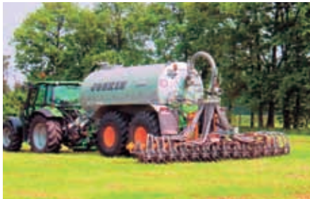
Sistema de inyección de estiércol.
