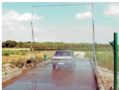
Desinfección externa de vehículo por aspersión.
