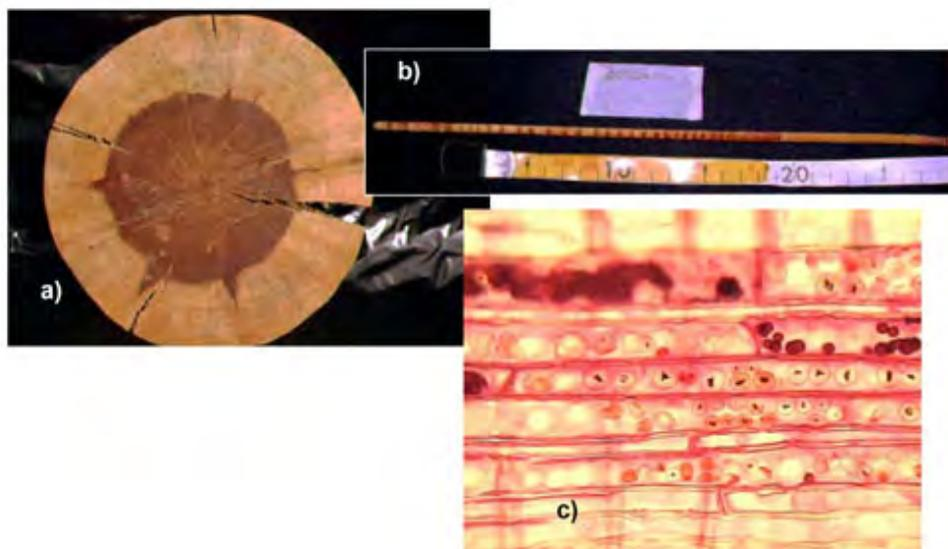
**Figura 3.** a) Rodaja de pino canario de 60 años con el duramen resinoso (tea) bien visible. b) Canutillo extraído con barrena Pressler correspondiendo a un ejemplar con 40 cm de diámetro de duramen a la altura del pecho. c) Gránulos de almidón acumulado en las células de parénquima de la madera. Fotos de J. Climent.
