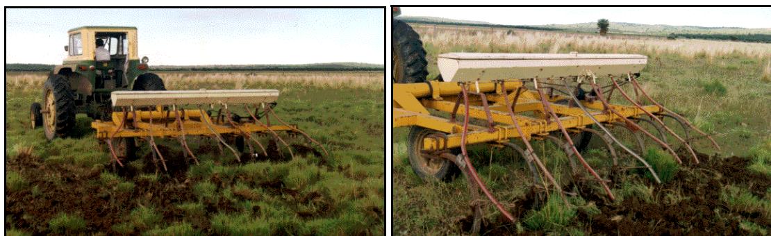
Cincelando e intersembrando con melilotus amarillo en primavera un llorón bien comido. Observar que los tubos del cajón sembrador casi arrastran por el suelo para evitar que el viento desperdigue la semilla.
