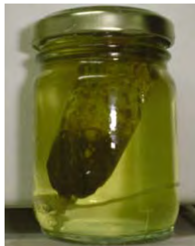
Figura 2. Rumen artificial en miniatura. Se observa el contenido gaseoso producto de la fermentación en la parte superior del saco, luego de 24 horas de incubación.
