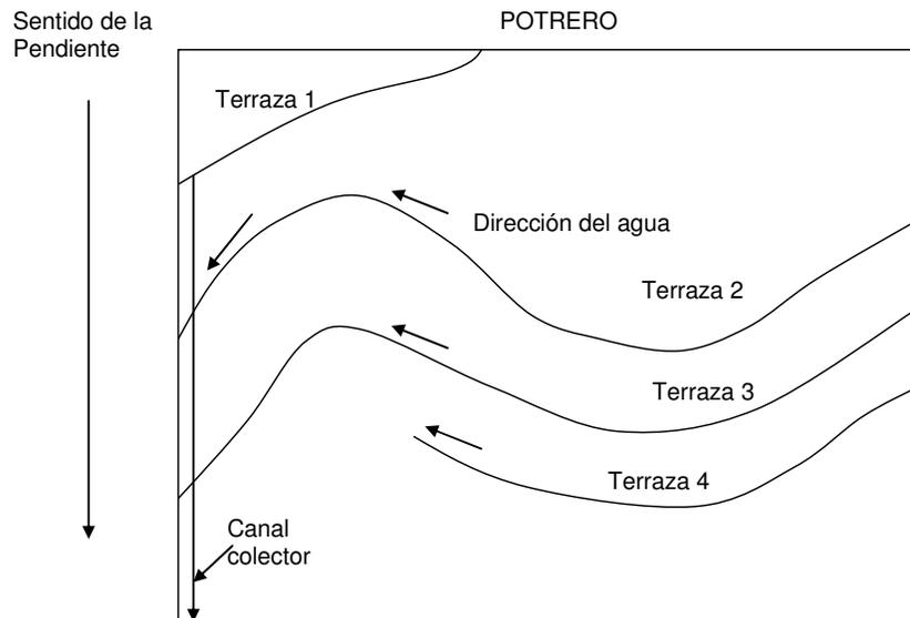
Las terrazas evacuan a un canal colector. El mismo debe estar bien empastado, debido a que recibirá concentrada el agua que no infiltró en el potrero. El canal colector finaliza en algún desagüe natural, arroyo o cañada.
