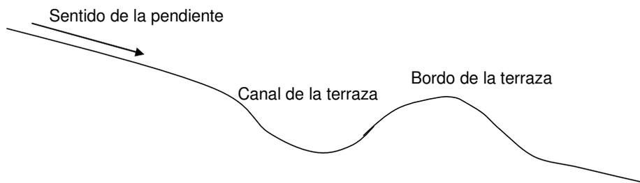
Una vez que el agua llega al canal de la terraza debe ser evacuada del potrero, por eso las terrazas tienen una pendiente interna de alrededor del 0,5 %. Esta pendiente evita que el agua se acumule en el canal y sobrepase el bordo. La pendiente del canal no puede ser mucho mayor al 0,5% para evitar que se produzca erosión en su interior.
