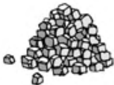
Material de relleno. (Cascote, escombros) 1 m 3 por cada metro de zanja.
