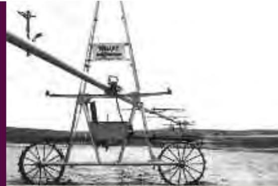
1952 | EN EEUU ZYBACH PATENTÓ EL SISTEMA DE RIEGO PIVOT CENTRAL CON AVANCE POR PRESIÓN DE AGUA | EN ARGENTINA SE INTRODUJERON RECIENTE EN 1970 | 6 A 7 KG/CM<sup>2</sup> DE PRESIÓN DE AGUA Y ASPERSORES TIPO MARTILLO
