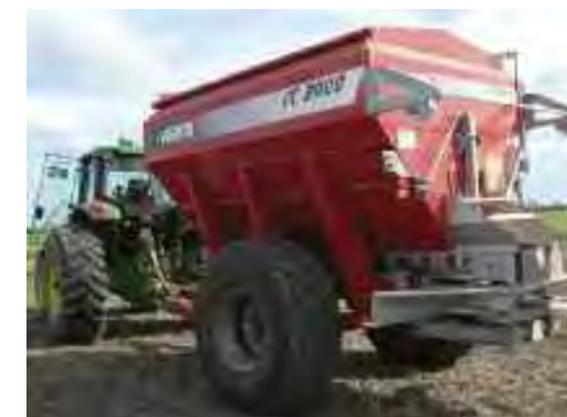
2003 | FERTILIZADORA AL VOLEO CON DOBLE PLATO Y ALIMENTACIÓN POR CINTA DE VELOCIDAD VARIABLE PARA TASA VARIABLE (VRT) | CAPACIDAD DE TOLVA: 5.000 LTS | EMPRESA FÉRTIL
