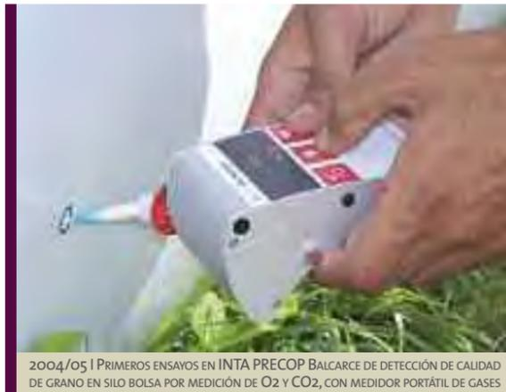
2004/05 | PRIMEROS ENSAYOS EN INTA PRECOP BALCARCE DE DETECCIÓN DE CALIDAD DE GRANO EN SILO BOLSA POR MEDICIÓN DE O<sub>2</sub> Y CO<sub>2</sub>, CON MEDIDOR PORTÁTIL DE GASES
