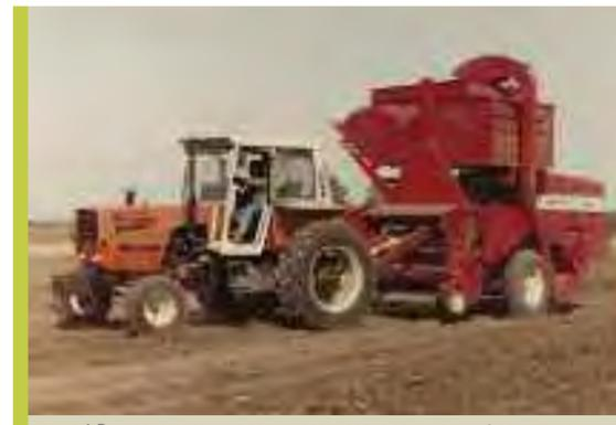
1995 | PRIMERAS COSECHADORAS - DESCAPOTADOTAS DE MANÍ CONSTRUIDAS EN ARGENTINA CON SISTEMA DE MULTICILINDRO DE DIENTES FLEXIBLES Y ALMACENAJE A GRANTEL CON TOLVAS DE DESCARGA POR GRAVEDAD
