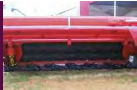
1997 | APARICIÓN GENERALIZADA DE LAS CORTADORAS/ACONDICIONADORAS CON DISCOS SOBRE BARRA FLOTANTE | MEJOR CALIDAD DE CORTE Y MENORES PÉRDIDAS DE CALIDAD POR MAYOR VELOCIDAD DE SECADO
