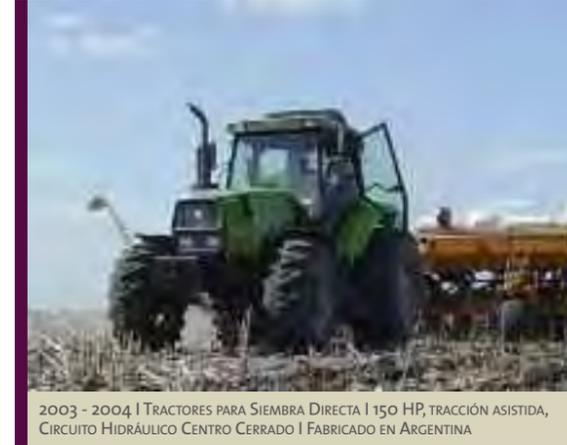
2003 - 2004 | TRACTORES PARA SIEMBRA DIRECTA | 150 HP, TRACCIÓN ASISTIDA, CIRCUITO HIDRÁULICO CENTRO CERRADO | FABRICADO EN ARGENTINA
