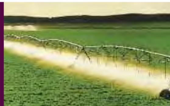
1996 | SE PRODUCE EL RÉCORD DE VENTAS DE PIVOT CENTRAL EN ARGENTINA (550 EQUIPOS) | PRESENTAN MAYOR LARGO, MAYOR SUPERFICIE DE COBERTURA, LA PRESIÓN DE AGUA DE LOS EQUIPOS SE REDUCE A 2 KG/CM<sup>2</sup> Y SE COMIENZAN A UTILIZAR LOS ASPERSORES CON CAÑO DE BAJADA ADAPTADOS A DISTINTOS AMBIENTES Y TIPOS DE SUELOS
