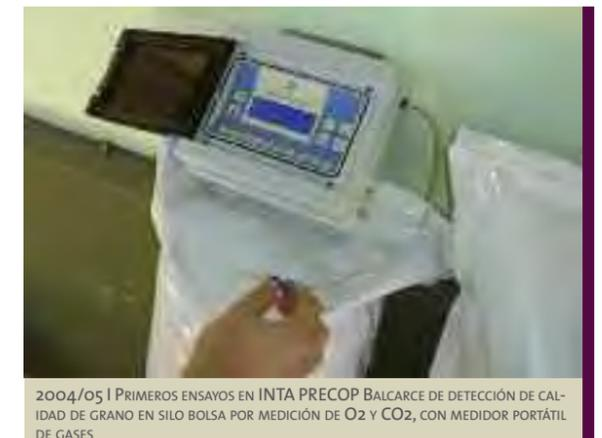
2004/05 | PRIMEROS ENSAYOS EN INTA PRECOP BALCARCE DE DETECCIÓN DE CALIDAD DE GRANO EN SILO BOLSA POR MEDICIÓN DE O<sub>2</sub> Y CO<sub>2</sub>, CON MEDIDOR PORTÁTIL DE GASES
