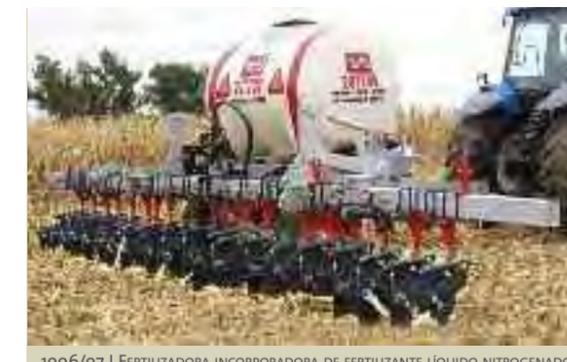
1996/97 | FERTILIZADORA INCORPORADORA DE FERTILIZANTE LÍQUIDO NITROGENADO (UAN) | BOMBA DE PISTÓN DE CAUDAL VARIABLE | VARIOS FABRICANTES ARGENTINOS: VHB, METALFOR Y JURI, ENTRE OTROS
