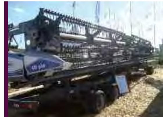
2009 | CABEZAL DE SOJA/TRIGO, DE 40 PIES DE ANCHO DE CORTE CON ALIMENTACIÓN POR LONAS, SUSPENDIDO SOBRE DOS RUEDAS CON SUSPENSIÓN NEUMÁTICAS | EMPRESA PIER-SANTI PLATAFORMAS
