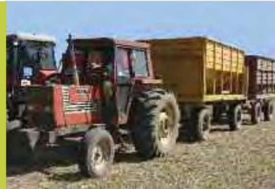
DESDE 1960 HASTA 1985 | ACOPLADOS TOLVA CON DESCARGA POR GRAVEDAD DE 8 Y 6 TONELADAS | SE UTILIZARON MASIVAMENTE
