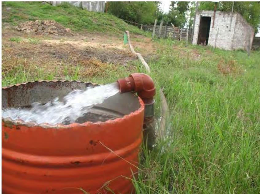
**Aforo volumétrico de la perforación donde se comprobó que extrae 12.000 ltrs/hora**
