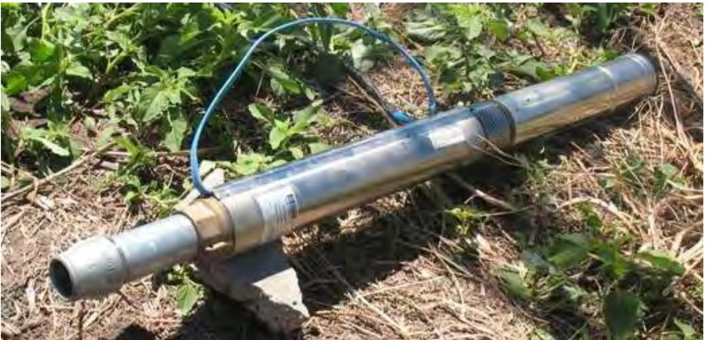
**Electrobomba sumergible con buje reductor para adaptarla a la cañería del molino**
