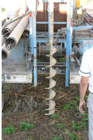
**Sistema rotativo de perforación para los primeros metros sin utilización de bentonita ( $\phi = 0,20$  m)**
