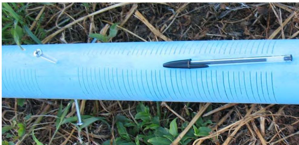
**Filtro artesanal construido por la Empresa de 75 mm de diámetro. Obsérvese los tornillos guía para un buen centrado dentro del caño camisa y poder engravar correctamente alrededor mismo.**
