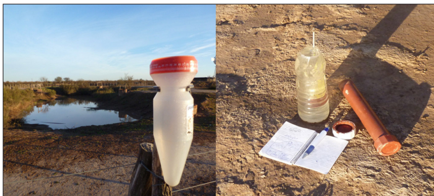
Figura 12. Pluviómetro y salinómetro utilizados para registrar precipitaciones y salinidad del agua de bebida para ganado.
