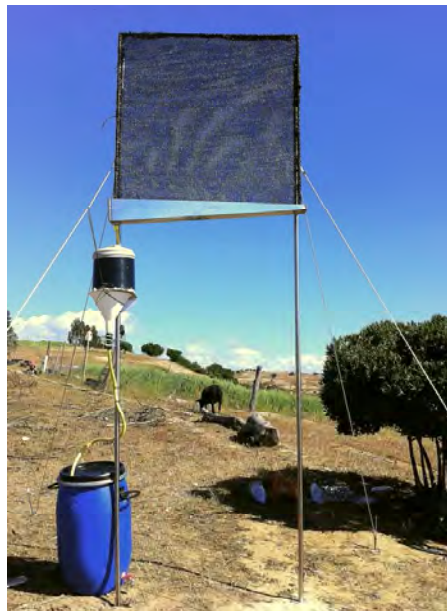
Figura 5. Standard Fog Collector, instalado en La Aguada, Comuna de Navidad, a 203 m.s.n.m. Región de O'Higgins, año 2012).
