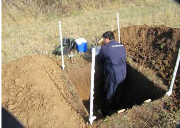
Figura 7. Trabajo de observación de un suelo a través de una calicata, que permite detectar problemas de pie de arado, entre otras características del suelo.
