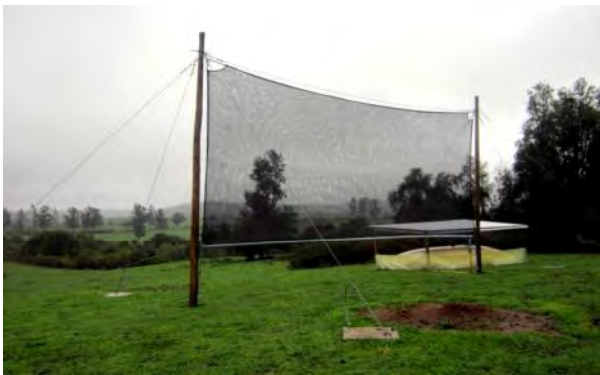
Figura 19. Sistema “atrapanieblas” y de agua lluvia, de 40 m 2 de superficie de captación. INIA-Hidango, comuna de Litueche. Región de O’Higgins.
