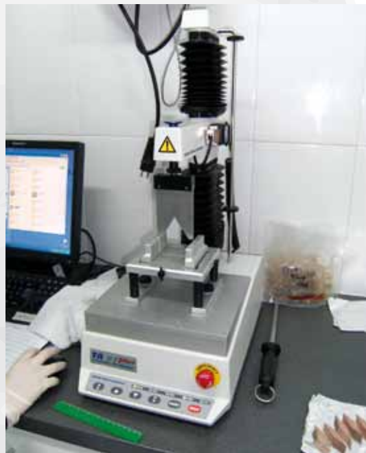
Preparación de muestras para evaluar la dureza de la carne (izquierda) y determinación de la resistencia al corte (dureza) con un texturómetro equipado con una sonda de corte (derecha)
