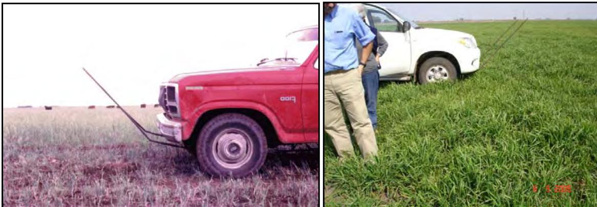
Vehículos con pasaalambres colocados; ver la forma y posición en el frente de las camionetas; corren bajo el chasis en todo su largo en su parte más baja, de manera que el hilo del eléctrico deslice bajo la camioneta sin engancharse en ninguna saliente.
