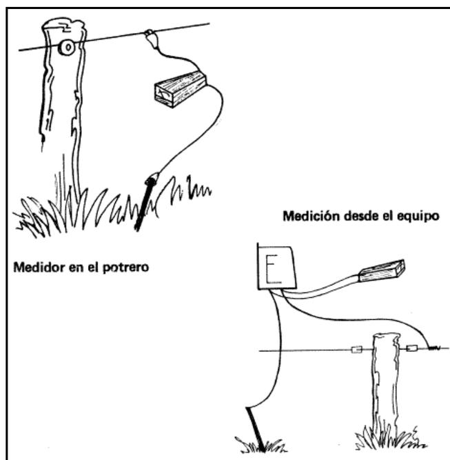
Figura 44.- Tipos de medidores de corriente.
