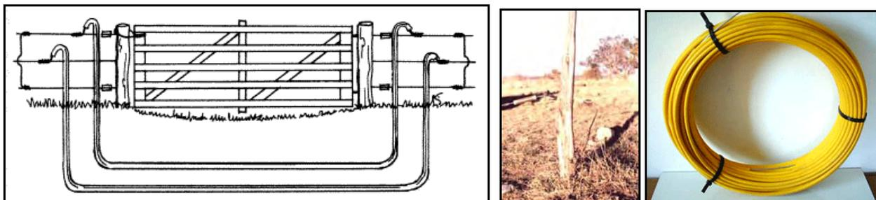
a)-Puente subterráneo. b)-Puerta de alambrado eléctrico con manija aislada; paso del cable subterráneo. c) Rollo de cable subterráneo
