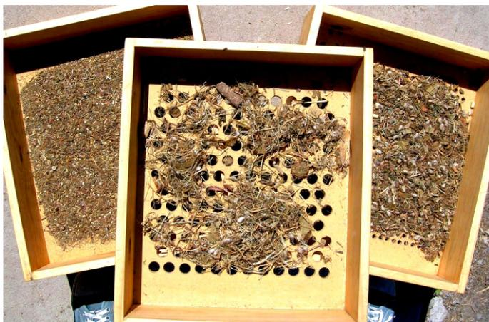
**Imagen N° 2:** Separador de Partículas "Penn State", para evaluar tamaños y distribución de partículas en henos, silajes y dietas TMR.
