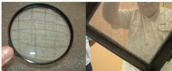
**Imagen N° 4:** Detalles de la 4ta bandeja incorporada al Separador de Partículas "Penn State", para la evaluación de dietas TMR.
