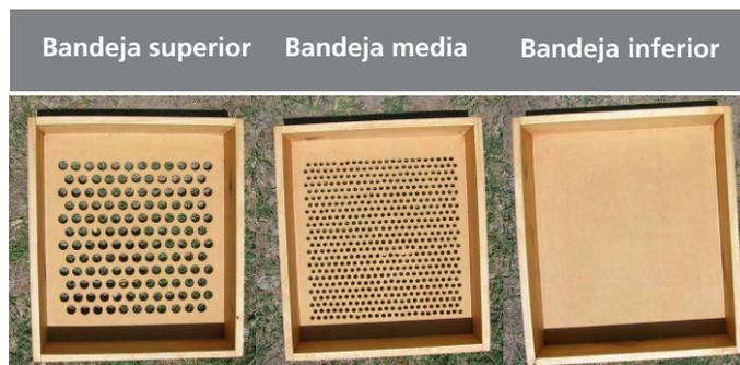
**Imagen N° 3:** Separador de partículas "Penn State" con sus correspondientes bandejas.
