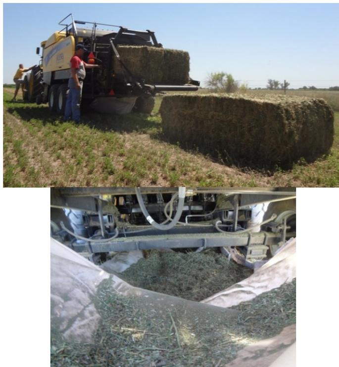
**Figura 4:** Ensayo de medición de pérdidas en cámara de compactación en megaenfadadora.
