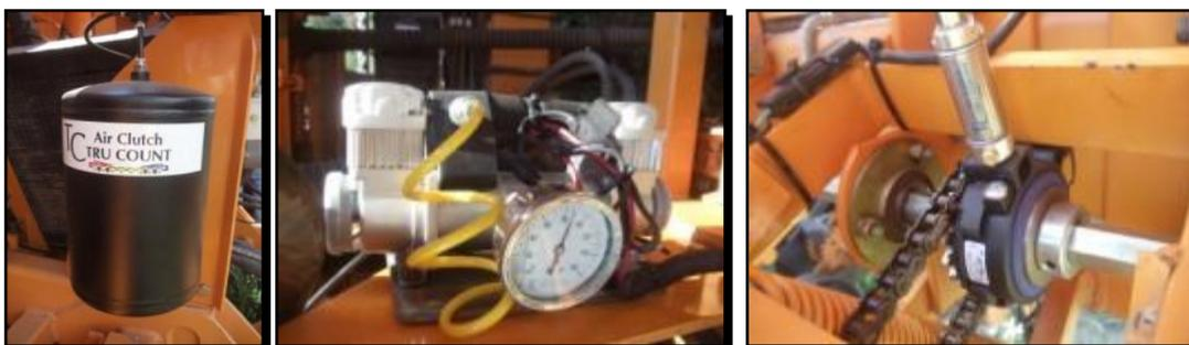
Figura 4: a) Reserva de aire "Pulmón neumático" b) Compresor de aire que mantiene la presión del pulmón de aire c) sistema electro neumático de corte para cada línea de siembra
