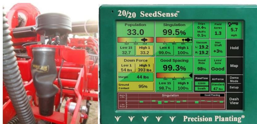
Figura 2: Sistema de amortiguación Neumática Down Force de Precision Planting
