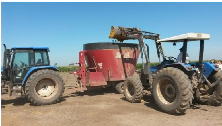
Mezclado de la ración utilizando mixers verticales. El orden de carga del mismo es 1) rollo de alfalfa, 2) silaje de trigo y 3) burlanda húmeda. La mezcla se realiza sin las trabas colocadas debido a que la fibra ya fue procesada al desmenuzar el rollo a menos de 7 cm y no tienen problema en cuanto a uniformidad y mezclado debido a que se emplea un 70% de la capacidad de carga del mixer.
