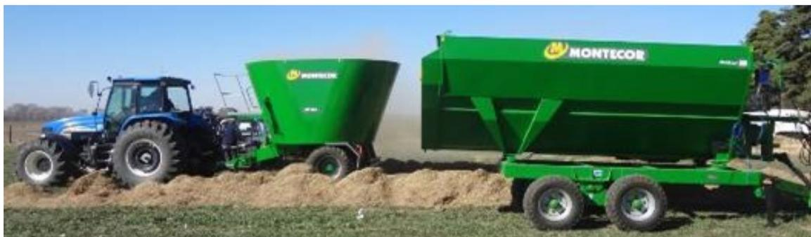
**Mixer desmenuzadores de porciones de rollos o megafardos y mezcladores de fibra muy larga: con sinfín trozador, reductor epicicloide y caja de alta y baja.**
