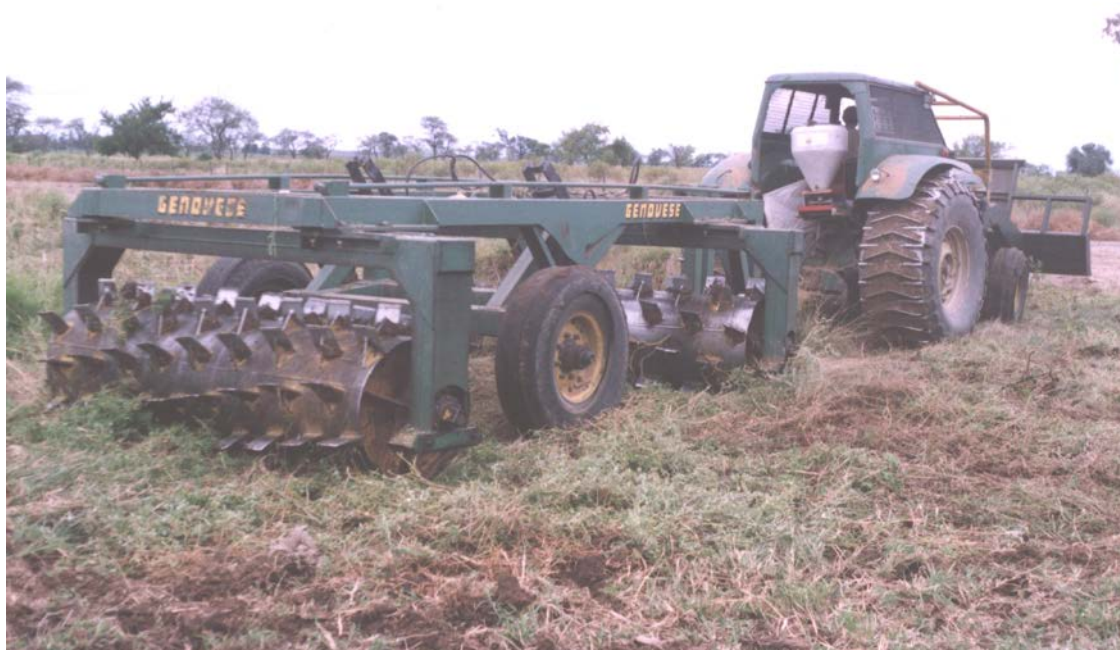
Foto 14: Foto 14.1: Rolos aireadores sin tren de traslado. Finca La Esperanza, Matará, Depto. Taboada, Stgo. del Estero. Foto 14.2: Implantación de Grama Rhodes cv. Callide con rolos aireadores y sembradora al voleo eléctrica en lotes de Grama Salina ( Aristida adsensionis ) y Cahiyuyo ( Atriplex spp ), Estancia La Celina, Depto. Río Hondo, Sgo. del Estero. Fotos: JRTV.
