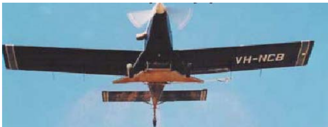
Foto 10: Siembra Aérea. Avión equipado con difusor Venturi.
