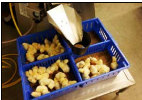
Figura 2. El Procesador de Servicio Avícola (PSP) de Nova-Tech clasifica las aves en las cajas.
