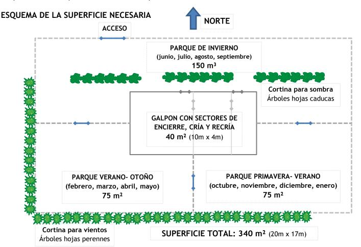
El galpón tuene techo a un agua, caída hacia el sur, piso de cemento con pendiente hacia la salida. Paredes oeste, sur y este cerradas, al norte zócalo de 80cm y resto ventana con alambre tejido hexagonal de 25mm (ver detalles a continuación).
