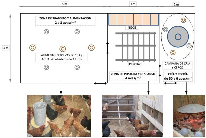
Los tabiques de separación entre zonas internas del galpón, tienen una altura de 1, 50 m y pueden ser de paneles de madera o chapa.
