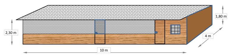
El techo del galpón conviene hacerlo con chapas de zinc. Los tirantes del techo son de  $2 \times 4$  pulgadas y van separados entre sí, a 1,50 m. Van 4 líneas de clavaderas de  $2 \times 2$ .
