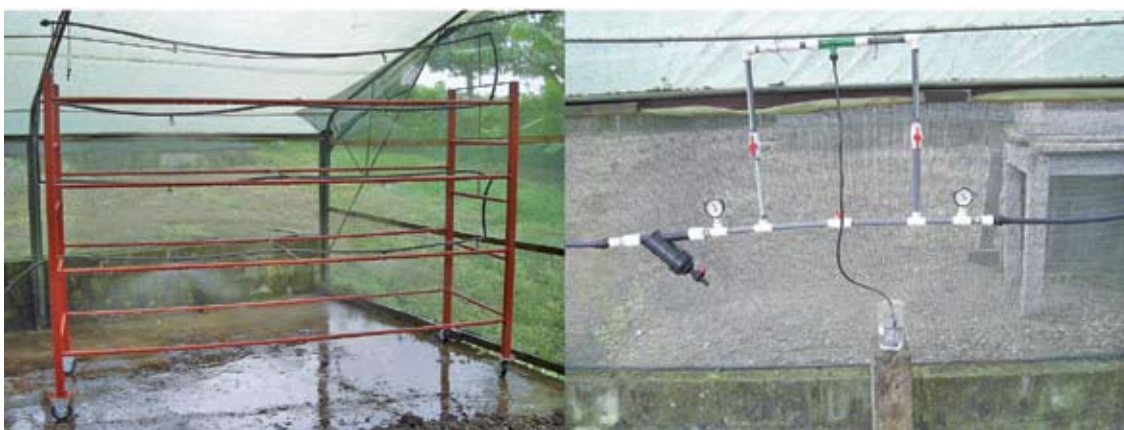
Figura 2. Estantería para producción de forraje verde hidropónico con el equipo de riego y el dosificador de nutrientes. Cartago, Costa Rica. 2007.
