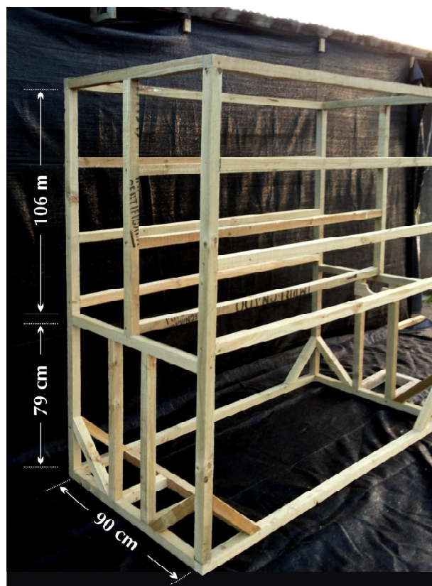
Figura 3. Vista lateral de la estructura, con pilares cortos para fijar el estanque y las repisas horizontales.
