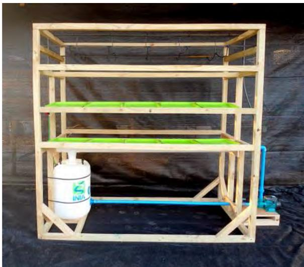
**Figura 11.** Vista frontal de la estructura, terminada, para producción de forraje hidropónico.
