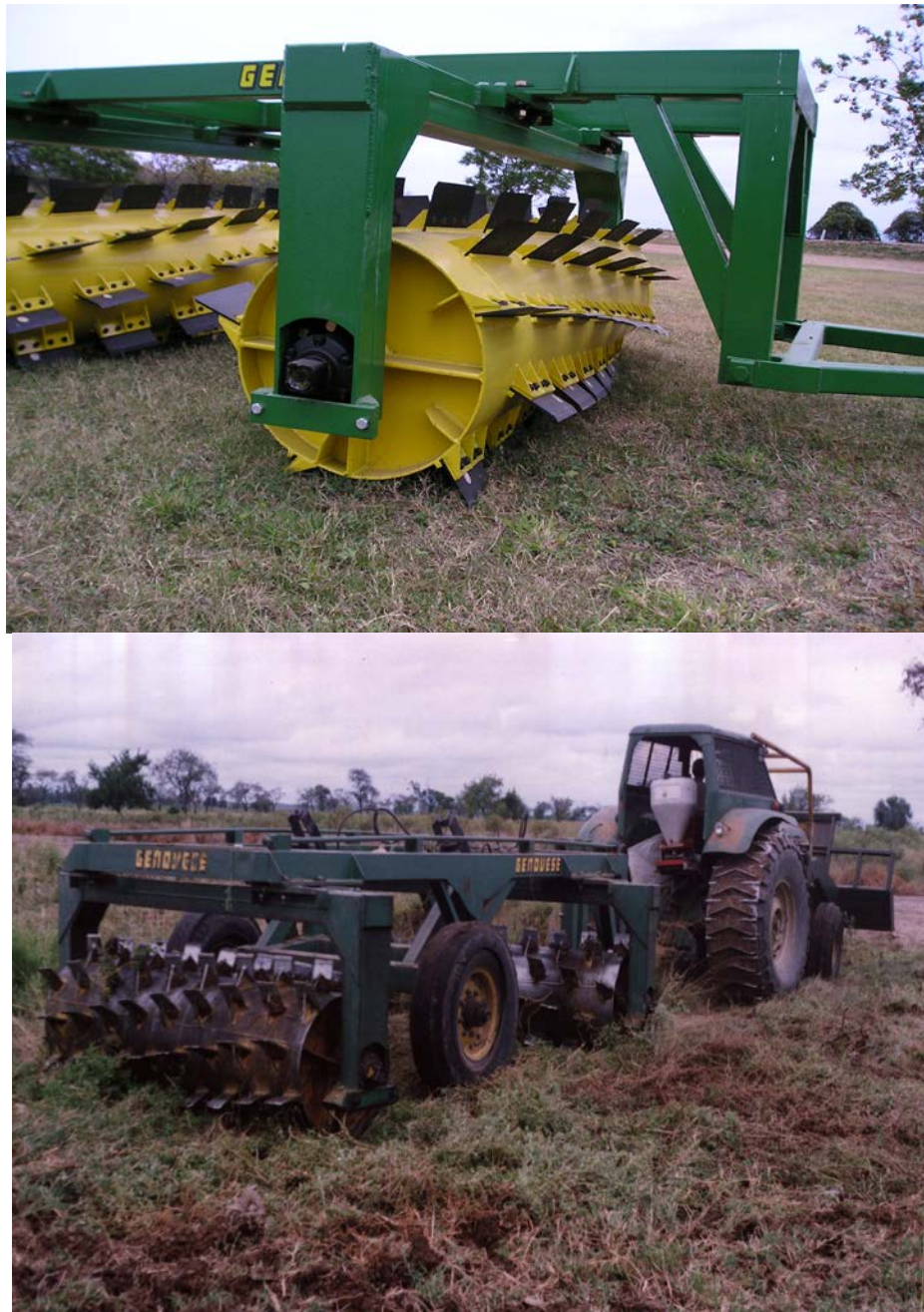
Foto 12: Arriba. Detalle de disposición de rolos y cuchillas. Abajo. Tractor acorazado, rolos aireadores con tren de traslado y sembradora al voleo eléctrica. Fca. La Celina, Dpto. Río Hondo, Stgo. del Estero.
