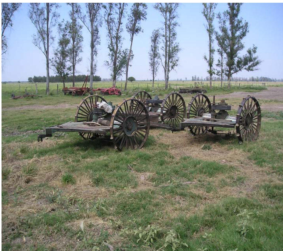
Foto 8: Desmalezadora pesada marca INRODA, de transmisión cardánica, en tándem, Estancias del Valle, Dpto. Jiménez, Stgo. del Estero.
