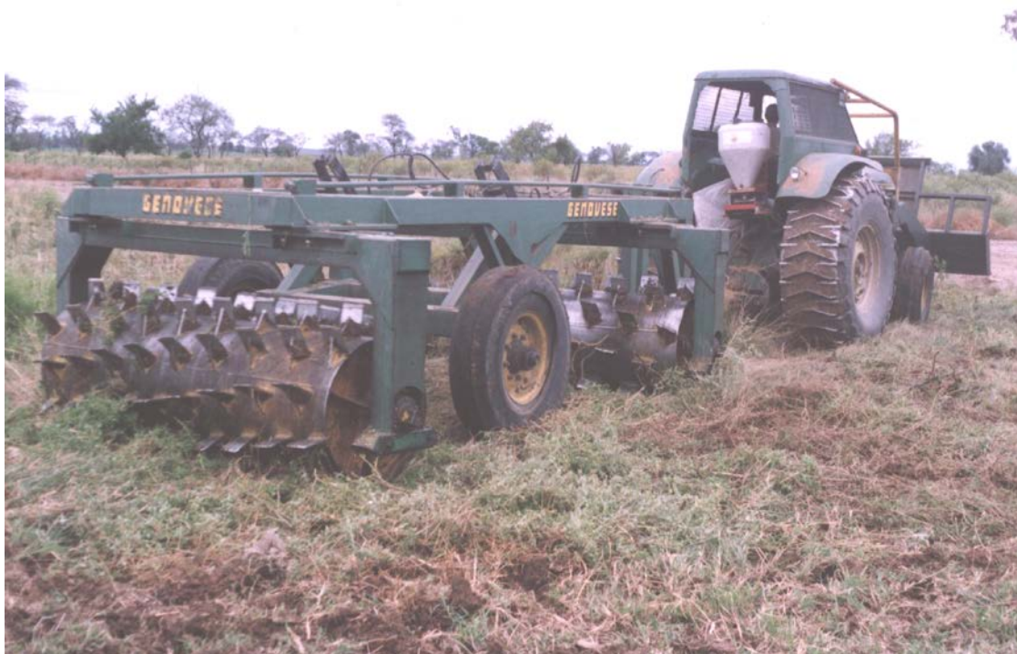
Foto 3: Implantación de Grama Rhodes cv. Callide (4n) con rolos aireadores y sembradora al voleo eléctrica en lotes de Grama Salina ( Aristida adsensionis ) y Cahiyuyo ( Atriplex spp ), Estancia La Celina, Depto. Río Hondo, Sgo. del Estero. Fotos: JRTV.
