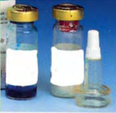
Añadir disolvente, homogeneizar **suavemente** (**no invertir ni agitar!!**) **Esperar 10 min** hasta rehidratación completa
