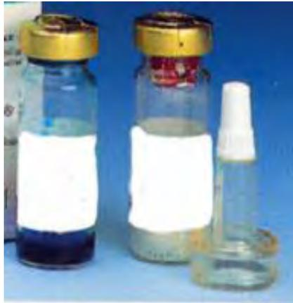
Añadir disolvente, homogeneizar **suavemente** (**no invertir ni agitar!!**) **Esperar 10 min** hasta rehidratación completa
